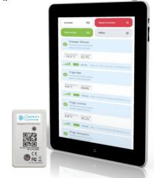
La Plateforme permet de suivre en temps réel tous les capteurs sur les différents points de vente. Les relevés de températures sont automatisés toutes les 20 minutes. Un rapport hebdomadaire est envoyé par mail pour archivage. Des alertes sont envoyés par SMS ou mail en cas de variation de températures.
